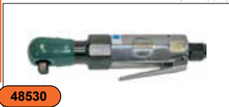
Трещотка пневматическая укороченная 3/8"DR, 230 об./мин., 34 Нм JAR-6313
