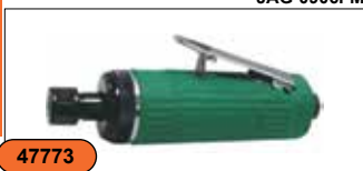
Бормашинка пневматическая, патрон 6 мм, 22000 об./ мин., 112 л/м JAG-0906FM
