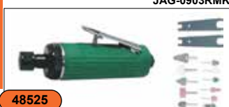
Бормашинка пневматическая, 152мм с насадками, набор, 6мм патрон, 25000 об./мин., 113 л/м JAG-0903RMK
