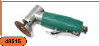
Угловая зачистная пневматическая машинка 2", 15000 об./мин., 114 л/м JAG-6603
